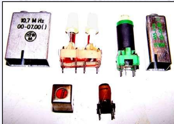
Links ein UKW-ZF-Doppel-Filter ohne Kondensatoren. Rechts ein AM-ZF-Filter ohne Kondensatoren. Unten ein AM-Filter für ein Transistorradio
