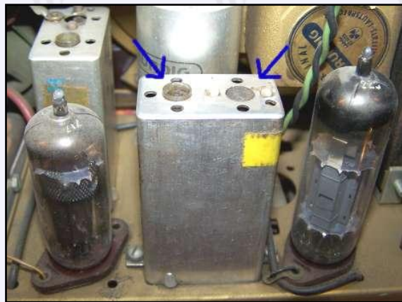
Typisches AM/FM-ZF-Filter, 2 Abstimmkerne oben und .....
