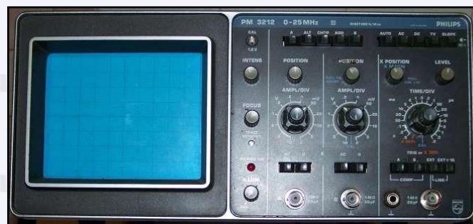
2-Kanal-Oszilloskop von Philips. 0 - 25 MHz.
