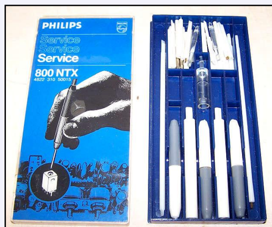
Das legendäre Abgleichbesteck von Philips 800NTX.
