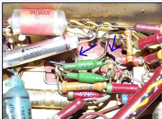
.... 2 Kerne von unten abzugleichen. Hier sieht man gleich auch recht gut den Unterschied zwischen Theorie und Praxis. Beide untere Abgleichzugänge sind richtig mit Bauteilen verbaut.
