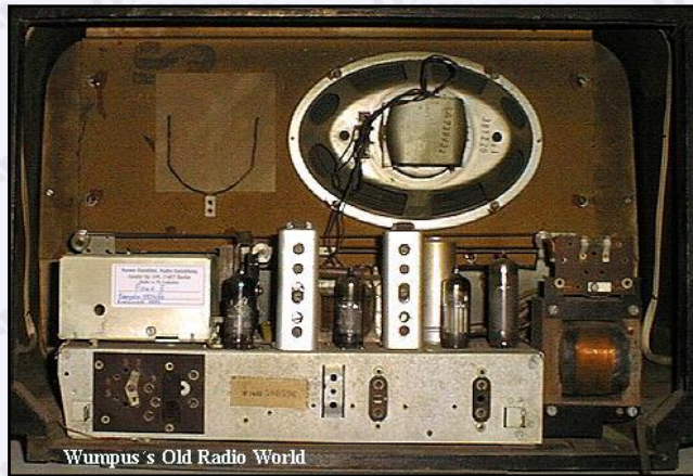
Ein Beispiel für ZF-Filter mit seitlichem Zugang zu den Spulenkernen.
